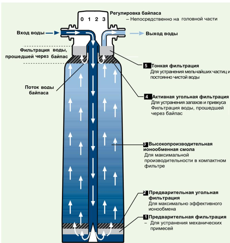
Конструкция фильтрующего картриджа BWT bestclear с 5-ступенчатой фильтрацией
